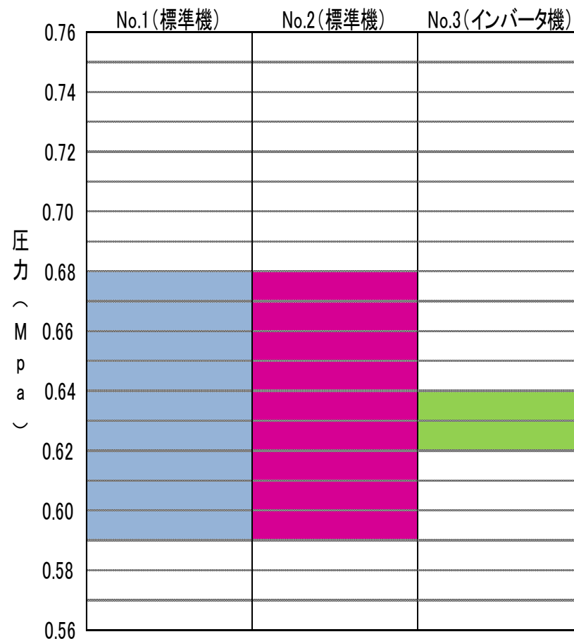
コンプレッサー圧力設定値(変更後)
