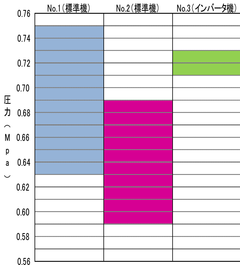
コンプレッサー圧力設定値(変更前)
