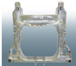
アルミ製のフロントサブフレーム (*FSW による連続接合)
