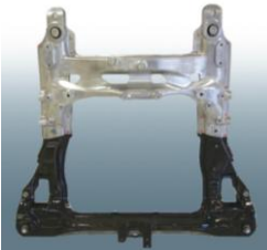
スチール製とアルミ製の フロントサブフレーム (*FSW による異種金属連続接合)
